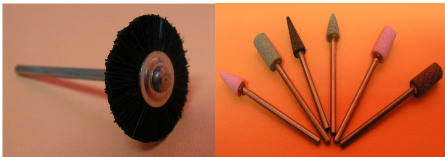
Figura 180. Perie și pietre montate.
