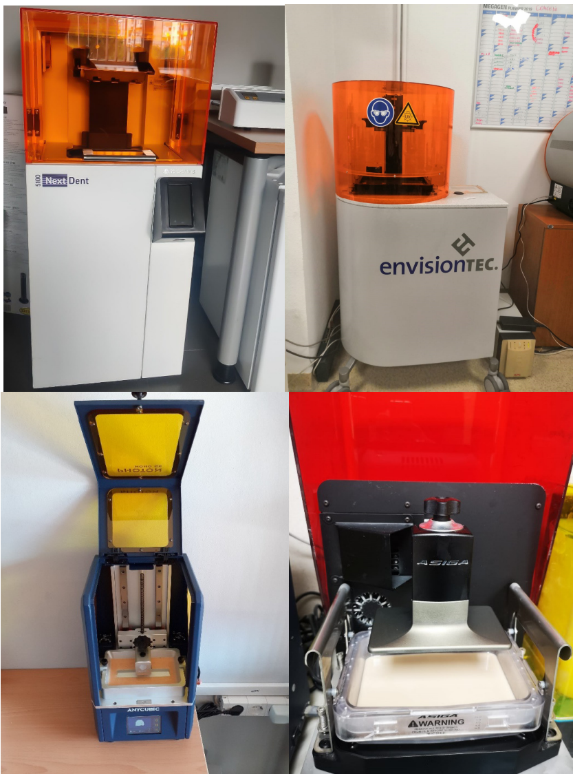
Figura 143. Imprimante 3D cu laser UV și materialul sub formă lichidă, conținut în cuva imprimantei.
