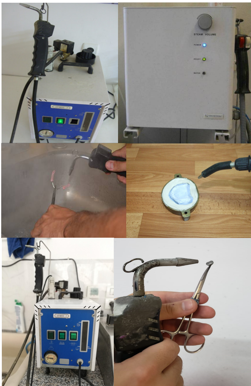
Figura 178. Aparat de curățare a suprafețelor cu ajutorul vaporilor de apă sub presiune.
