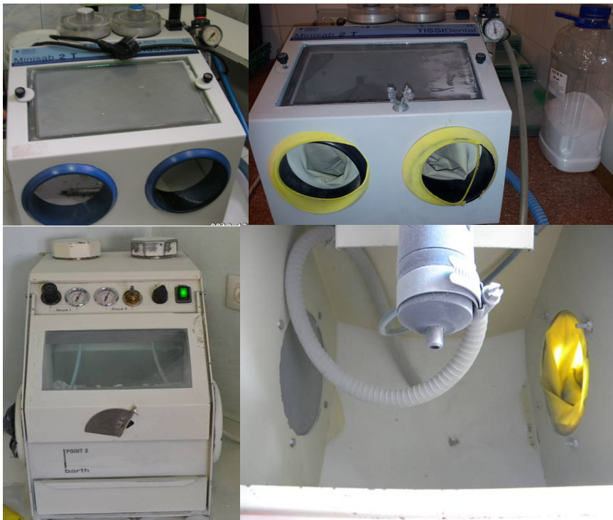
Figura 125. Sablatoare și incinta sablatorului.
