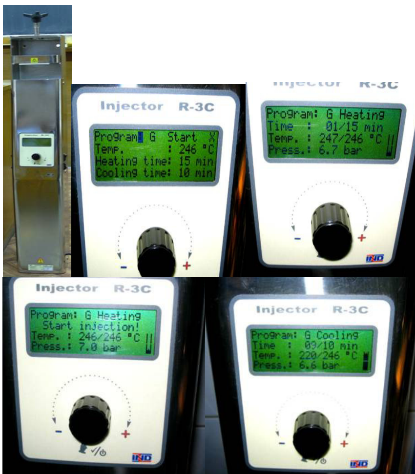
Figura 134. Injectorul R 3-C și timpii programului de injectare a materialului termoplastic: start, încălzire, injectare, răcire.
