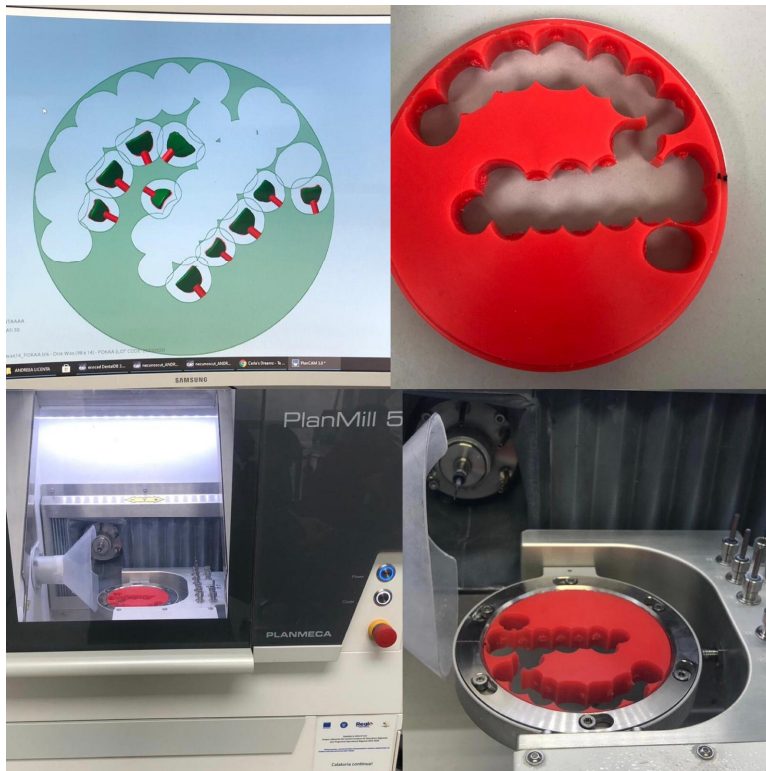
Figura 88. Obținerea machetelor din ceară prin frezaj computerizat.
