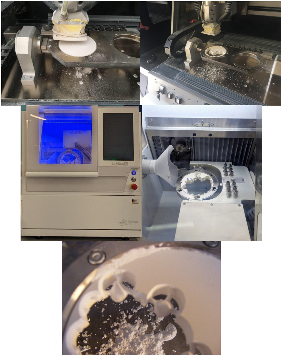
Figura 170. Frezarea unui disc de zirconia.
