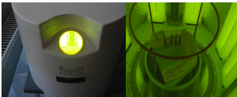
Figura 138. Cuptor de fotopolimerizare Targis Power, cu căldură și lumină, și fotopolimerizarea unei restaurări protetice.
