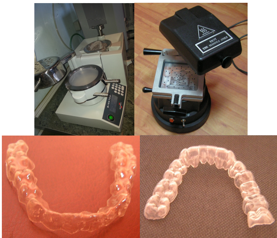
Figura 21. Aparate pentru termoformare și gutiere obținute prin termoformare.
