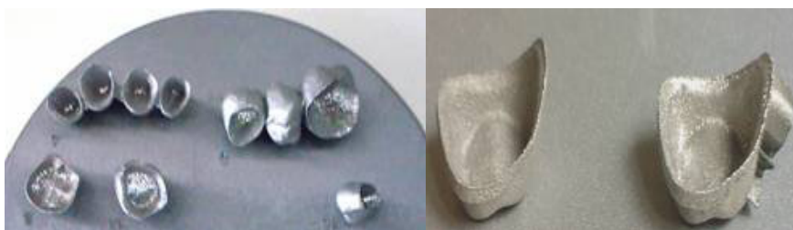
Figura 123. Scheletul metalic ar unor viitoare restaurări protetice fixe, după detașare de pe platformă.
