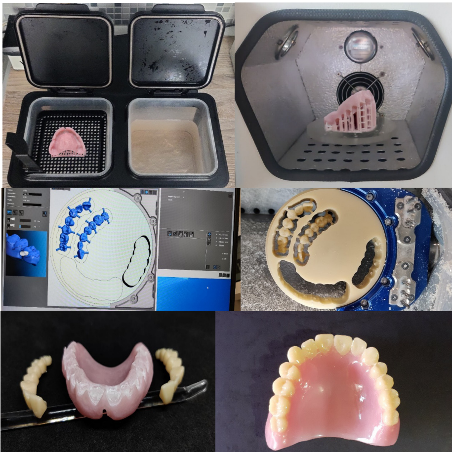
Figura 146. Workflow de realizare a unei baze de proteze prin 3D printing (Stereolitografie-SLA): Modelul virtual, obținut prin scanarea modelului fizic; Designul digital al probei de proteză (try-in); Try-in obținut prin 3D printing; Designul digital al bazei protezei; Baza de proteză obținută prin 3D-printing; Curățarea cu izopropanol; Fotopolimerizarea adițională; Realizarea dinților artificiali prin frezare; Atașarea dinților la baza protezei; Proteza finalizată.
