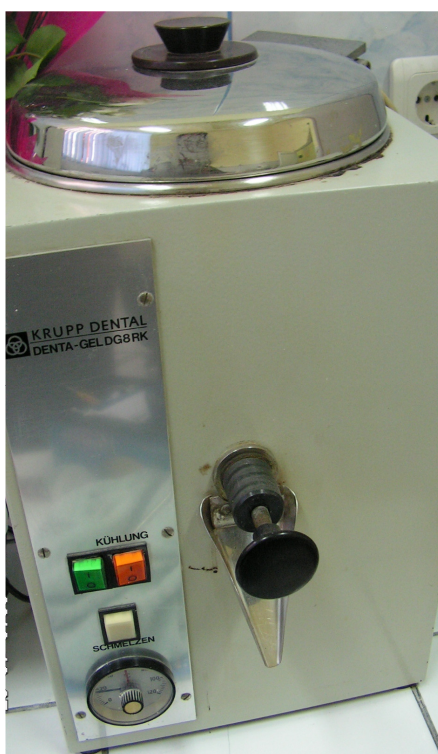
Figura 30. Aparat pentru prepararea hidrocoloizilor reversibili pentru duplicare.
