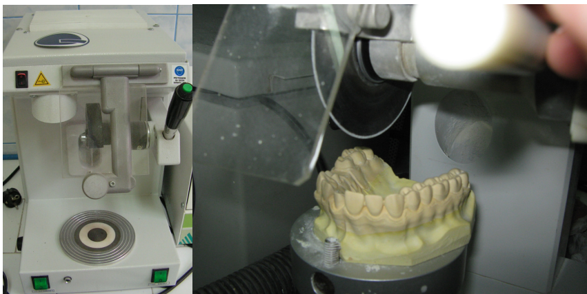
Figura 50. Aparat tip model-cut și secționarea modelului cu aparatul tip model-cut.
