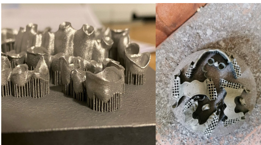
Figura 122. Elemente protetice, înainte de detașarea de pe platforma de construcție.
