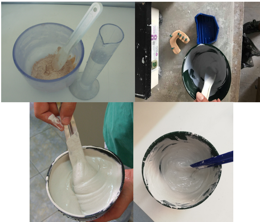
Figura 35. Pulberea și apa pregătite pentru preparare și prepararea manuală a gipsului.
