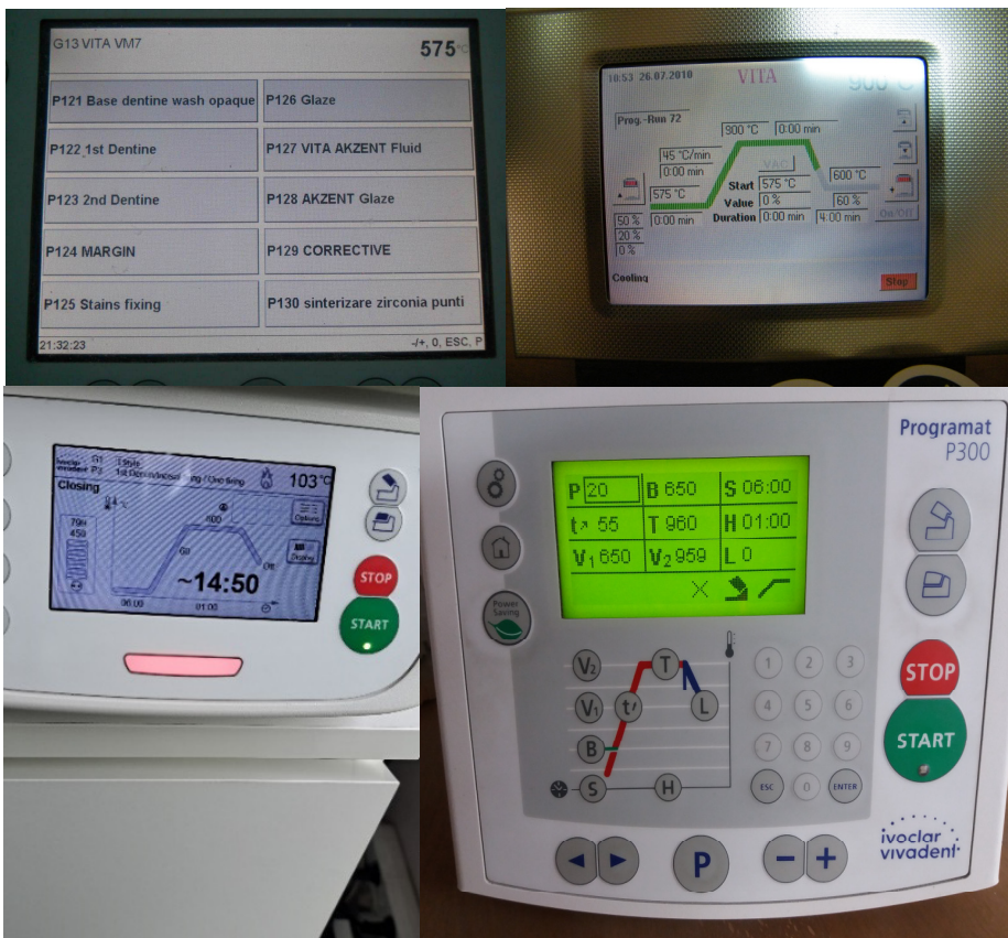
Figura 153. Programe de ardere și afișarea unui programelor pe display-ul aparatului.
