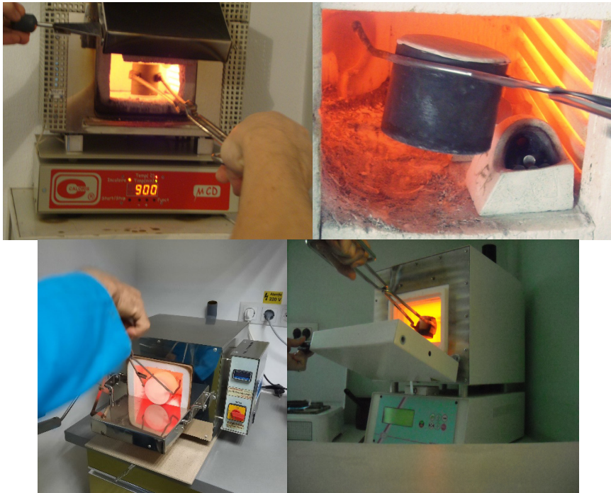
Figura 102. Manipularea tiparului, utilizând cleștele special.
