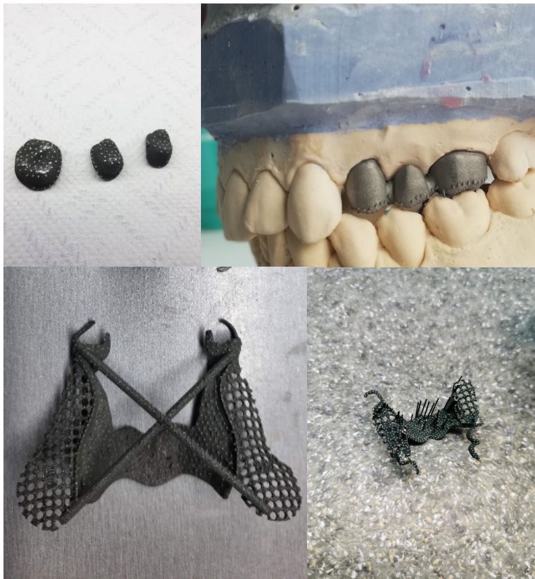
Figura 124. Schelete metalice ale unor restaurări protetice diverse, obținute prin SLM.
