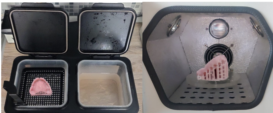
Figura 144. Post-procesare: curățare cu soluție alcoolică și fotopolimerizare adițională a unei baze de proteză.
