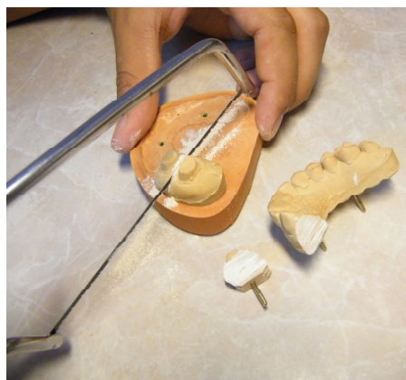
Figura 48. Secționarea modelului cu ajutorul unui fierăstrău manual pentru gips.
