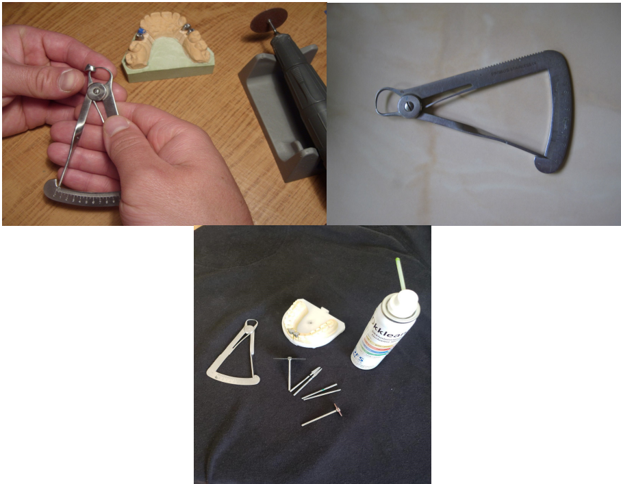
Figura 7. Instrument pentru măsurarea grosimii coroanelor/capelor.
