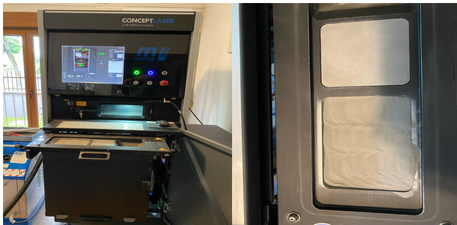
Figura 119. Imprimantă laser PBF și pudra metalică utilizată.
