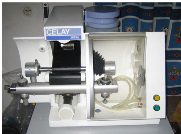
Figura 175. Sistemul CAM (frezare prin copiere) Celay (Mikrona).
