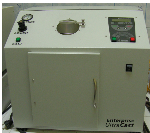
Figura 114. Aparat de topire/turnare cu vacuum și presiune, dotat cu atmosferă protejată (argon), pentru toate tipurile de aliaje, inclusiv titan.
