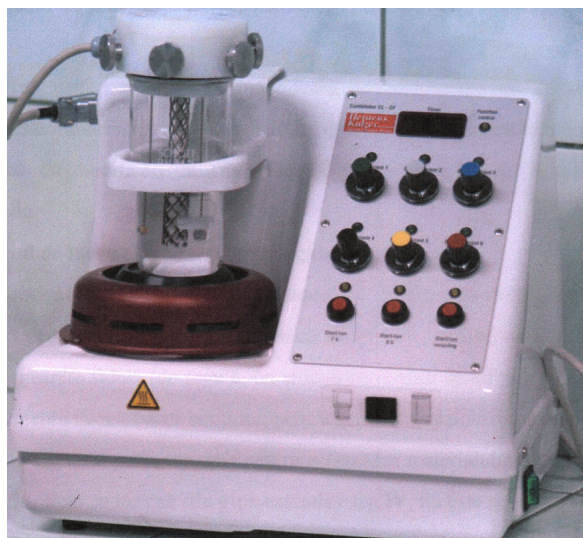
Figura 118. Instalație de galvanofornare.
