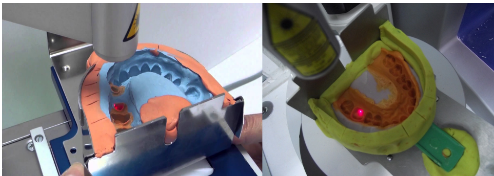
Figura 59. Localizarea poziției lăcașurilor pentru pini cu ajutorul unei laser.
