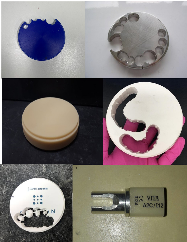
Figura 165. Diverse blocuri pentru frezare CAD/CAM: ceară, aliaj Co-Cr, rășină acrilică, PEEK, zirconia, ceramică feldspatică.
