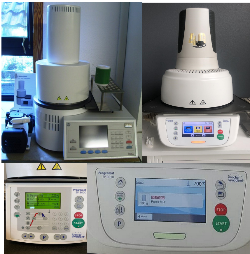
Figura 159. Cuptoare pentru arderea și presarea ceramicii Programat EP 3000 și EP3010 (Ivoclar Vivadent).
