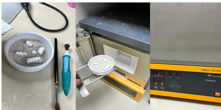
Figura 162. Sinterizarea RPF din ceramică pe bază de zirconia.
